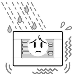
L'installazione in zone umide, con spruzzi d'acqua o con vibrazioni significative può causare guasti.
