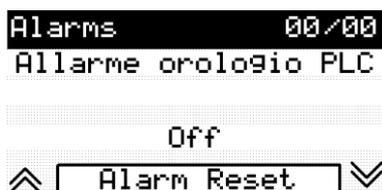
Questo menu mostra tutti gli allarmi attualmente presenti nel modulo AWS e gli allarmi non più presenti ma che necessitano del reset manuale. Gli allarmi si resettano premendo a lungo sul tasto **Alarm reset**. Il modulo AWS Master comunicherà anche gli eventuali blocchi dei moduli AWS controllati senza dare però indicazioni specifiche sul tipo di errore.
